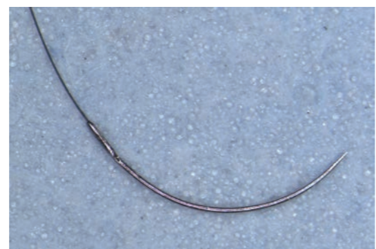
微細な針に糸を取り付ける作業は顕微鏡下でおこなわれる。針にU字型の溝をつけ、糸を閉じ込めるという昔ながらの技法を用いている。
