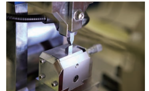
大きめの針は別のフロアで作業されている(上)。30ミクロンの針に糸を埋め込むための溝をつける機械。顕微鏡下で集中力のある作業だ(中・下)
